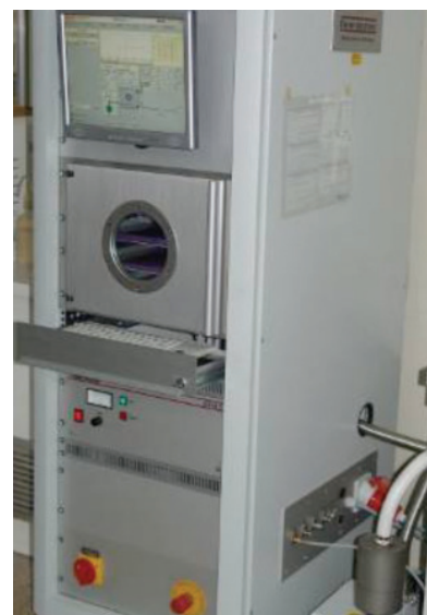
a) Plasma a baixa pressió. L'esterilització es realitzaria en discontinu dins una cambra de buit.
