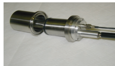
Sensor d'ampli camp de visió per monitorització de la sinèresis en la cuba de quallar.
