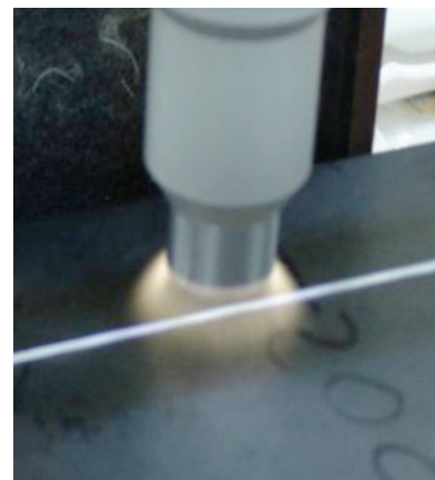
b) Plasma a pressió atmosfèrica. L'esterilització es realitzaria en continu.
