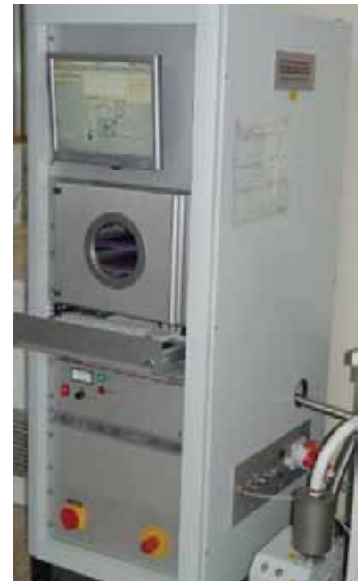
Equip de plasma a baixa pressió. Permet treballar en discontinu.
