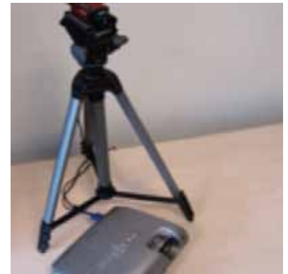
Càmera i canó de projecció utilitzats en l'scanning 3D
