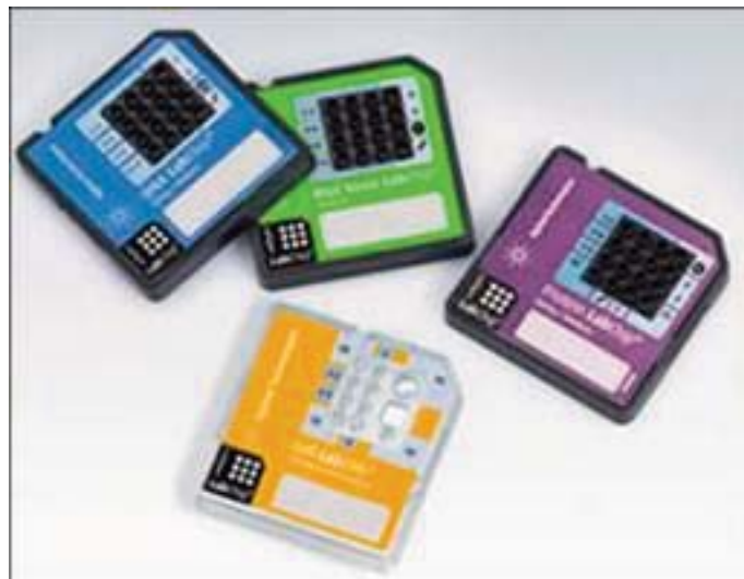
Figura 11. Dispositiu de diagnòstic lab-on-a-chip de Agilent Technologies © 2007. Reproduït amb permís.
