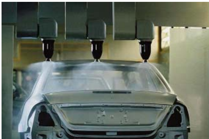
Figura 13. Recobriment de nanopartícules de Mercedes-Benz per augmentar la resistència a ratllades i la lluentor (Font: DaimlerChrysler).
